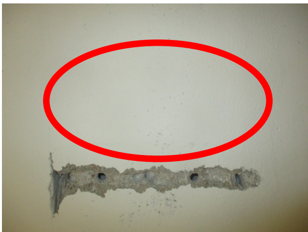
foto/7/ Pohled na zkoušenou plochu - ověření pevnosti betonu nedestruktivní zkouškou (S1)
