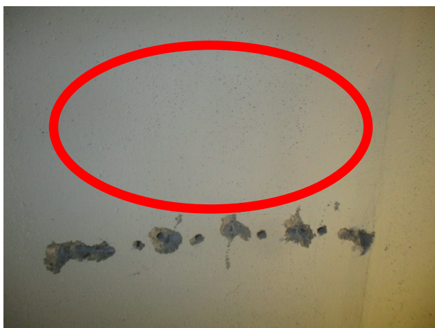
foto/11/ Pohled na zkoušenou plochu - ověření pevnosti betonu nedestruktivní zkouškou (S2)
